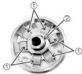
شکل ۲۴) نشیمنگاه فلزی غلتک وزنه ای کلاچ جلو
