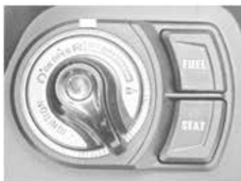
شکل ۱۸ کلید قطع و وصل سوخت رسانی
