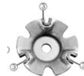
شکل ۲۵) درپوش فلزی غلتک وزنه ای کلاچ جلو
